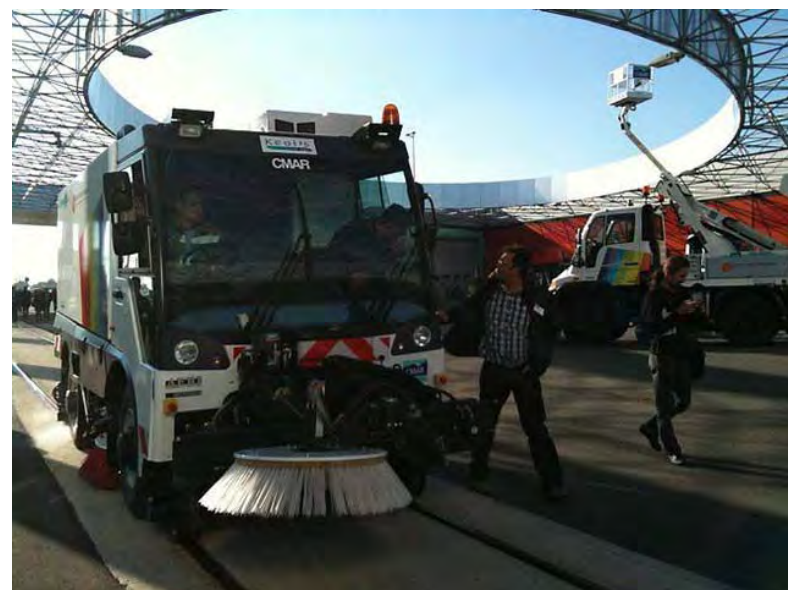
Figure 10 : Balayeuse rail/route pour la plateforme et le rail
