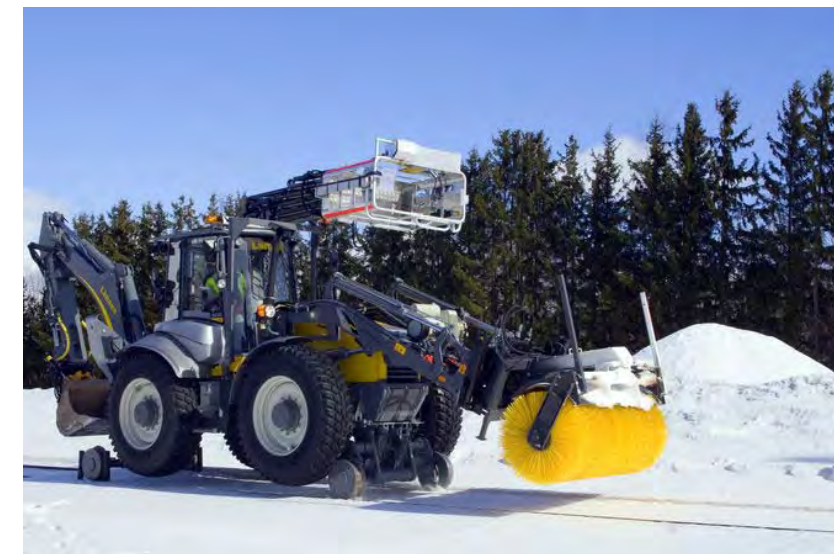
Figure 9 : Véhicule rail/route muni d'un balai
