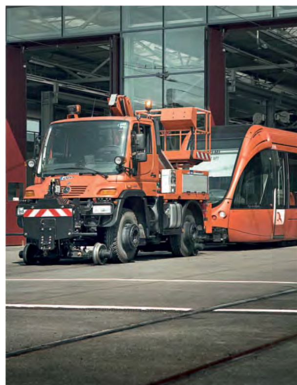
Figure 11 : Véhicule rail/route tractant une rame
