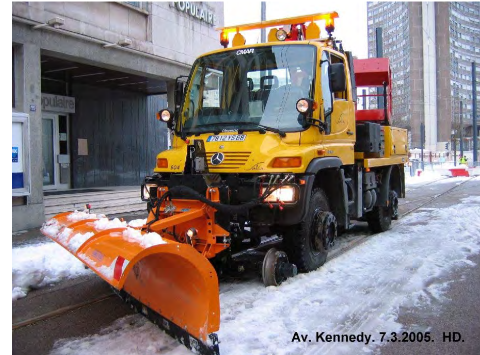
Figure 8 : Véhicule rail/route muni d'une charrue
