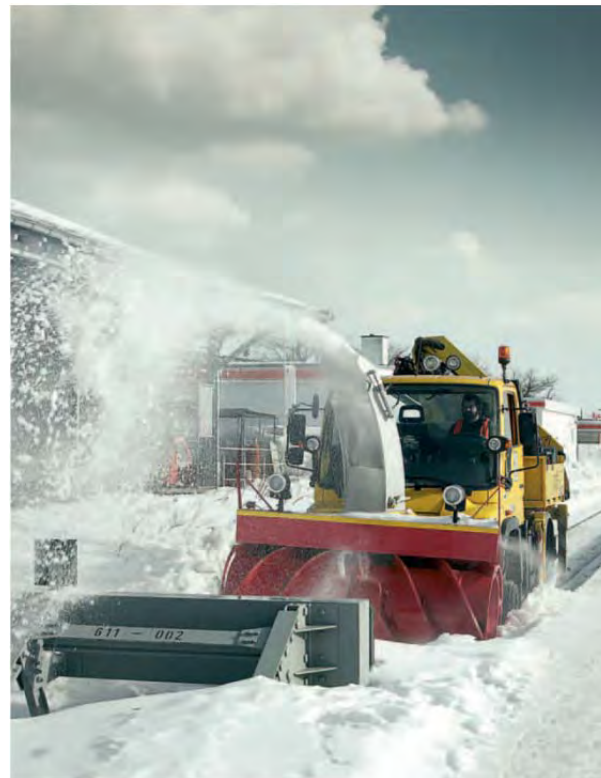
Figure 7 : Véhicule rail/route muni d'une souffleuse
